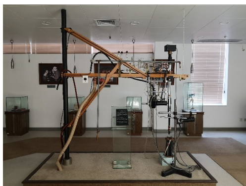
图2 吴健雄小组在做弱相互作用中宇称不守恒实验时所用仪器的等比模型 (原实验设备现存在美国国家标准计量局, 刘金岩摄于东南大学吴健雄纪念馆)
