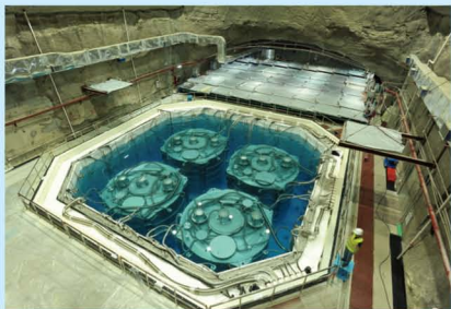
安装在巨型水池中的中微子探测器
