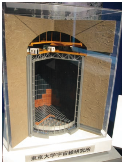
图 2 神冈实验 KamiokaNDE 的探测器模型，橙色为光电倍增管。探测器分为光学独立的内外两层以便能够区分带电的粒子是来自探测器之外还是产生在探测器内部
